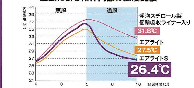
エアライト搭載の2モデルは帽体内部の温度が上がりにくく、特にエアライトS搭載のST#123-JZVは通風後、急激に温度が低下します。
