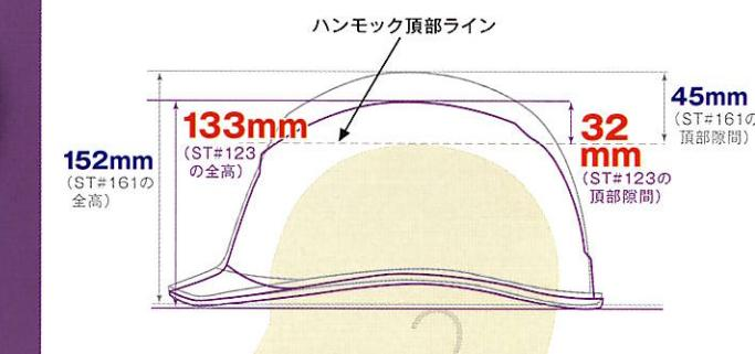
従来モデルは、帽体とハンモックの間に衝撃を吸収するための空間が45ミリ必要でしたが、新開発のサポートブロックによりこの空間を約32~34ミリに抑え、全高13.3センチとコンパクトに。ヘルメットを足場にぶつけてしまう回数などは、飛躍的に少なくなると期待できます。
